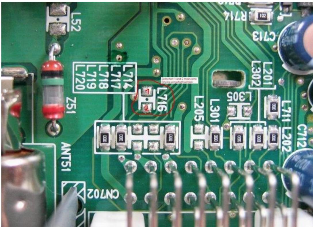
Abbildung 2: Brücke L716 auf der Platine
