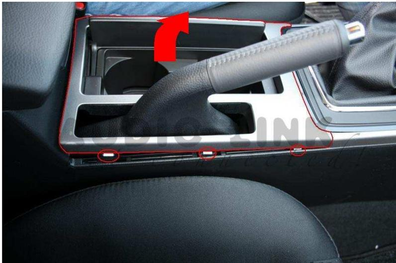
Die Abdeckung der Mittelkonsole um den Hebel der Feststellbremse abnehmen. Diese ist nur mit Klipshalterungen befestigt. Zuerst hinten aushebeln und dann vorne in Richtung der Gangschaltung, dann vorsichtig über den Hebel der Feststellbremse abnehmen (siehe Pfeil).
