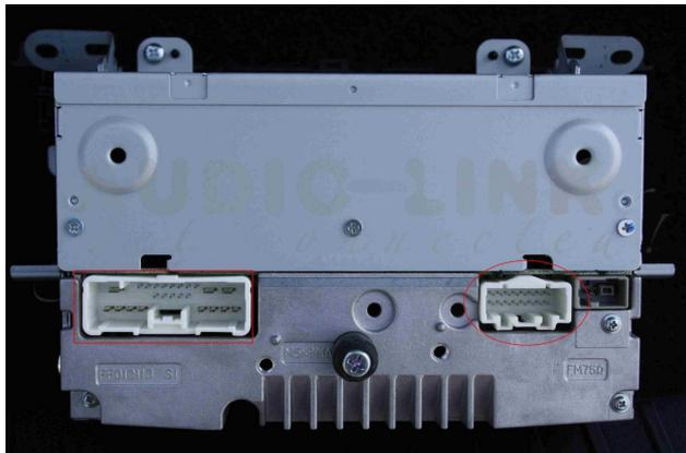
Den Hauptstecker auf der linken Seite (1) und den Stecker an der Wechslersteuerung (2) abziehen. Beide Stecker am Adapter anschließen. Den Adapter dann zuerst wieder mit dem Radio (1, 2), dann mit dem Audio-Link verbinden. Das Massekabel an der Fahrzeugkarosserie verschrauben und erst ganz zum Schluss die Masse der Batterie wieder anklemmen.
