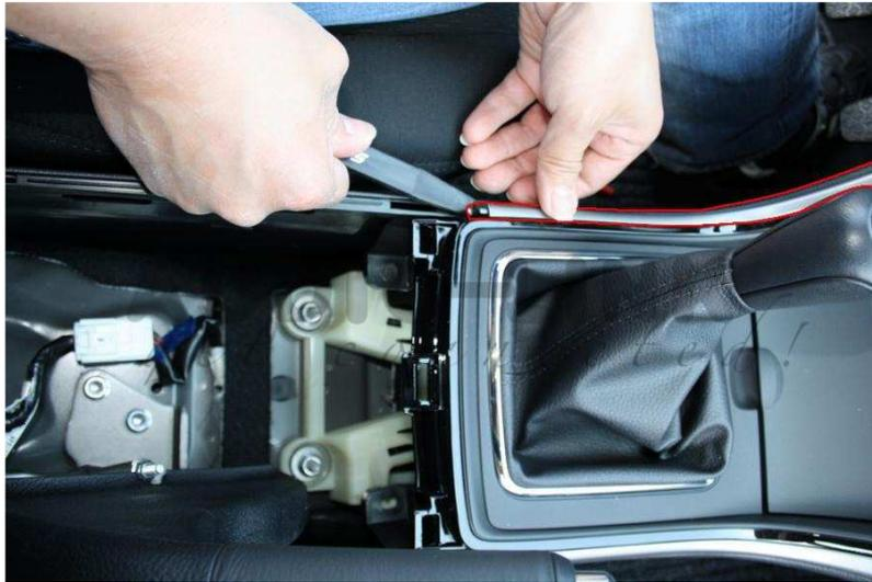
Die Blende links von der Gangschaltung entfernen. Diese ist mit 6 Klipshalterungen entlang der Mittelkonsole befestigt. Zuerst unten aushebeln und dann nach oben bis zur Lenksäule.
