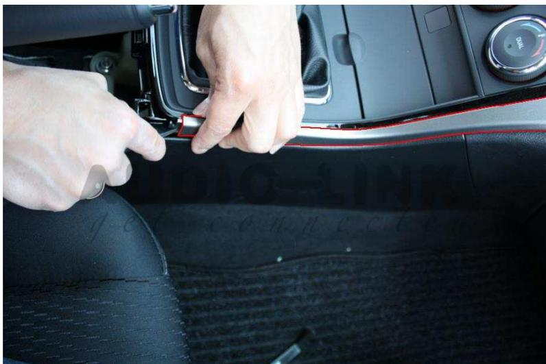
Ebenso die Blende rechts entfernen. Diese ist mit 10 Klipshalterungen befestigt und reicht bis übers Handschuhfach.
