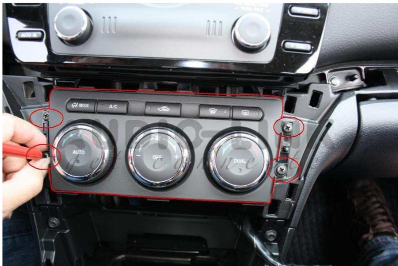
Nachdem die Verkleidung abgenommen wurde können 4 Schrauben gelöst werden, je zwei auf jeder Seite der Klimaanlagesteuerung. Danach die Klimaanlagesteuerung herausziehen.
