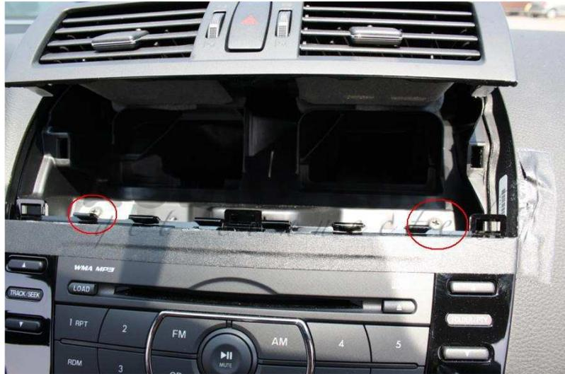
Hinter der Lüftung befinden sich zwei Schrauben. Hinter der Klimaanlagesteuerung unterhalb des Radios befinden sich ebenfalls zwei Schrauben. Sind alle 4 Schrauben gelöst, kann das Radio nach vorne herausgezogen werden.
